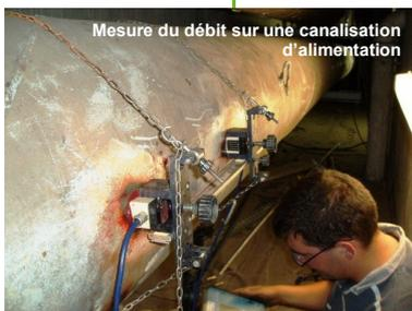
hydratec a élaboré et mis en œuvre un protocole d'essais : dans un premier temps sur l'usine complète au débit maximum de l'exhaure d'eau brute durant 24 h, puis sur chacune des 3 files de traitement pour plusieurs débits et en faisant varier le nombre de filtres en fonctionnement.
